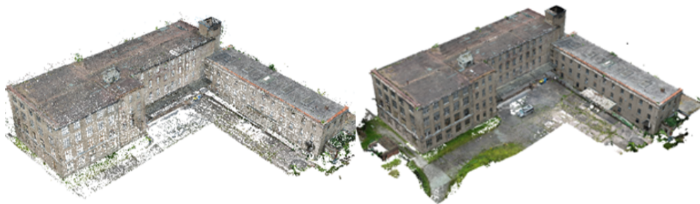
Abbildung 6.5: dünne (links) und dichte Punktwolke (rechts)
