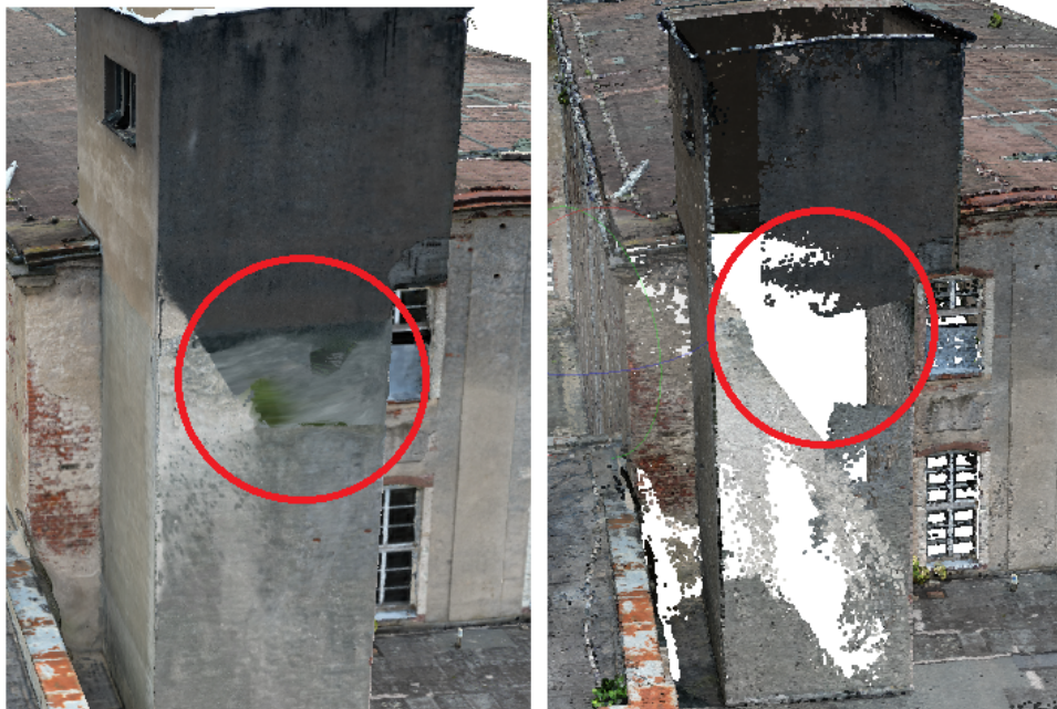
Abbildung 8.5: Qualität bei Lücken (links im Modell und rechts die Lücke in der Punktwolke)
