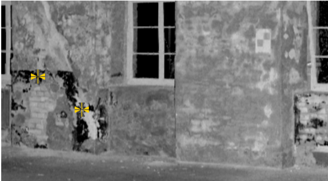
Abbildung 5.3: Beispiel für Fehler der automatisierten Auswertung: Im linken Bildbereich werden zwei vermeintlich erkannte Zielmarken angezeigt, während die richtige Zielmarke in der Mitte nicht erkannt wurde.
