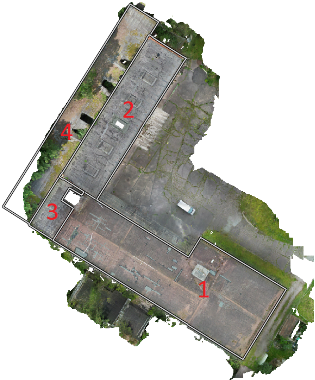
Abbildung 6.9: Dachpolygone im Orthomosaik
