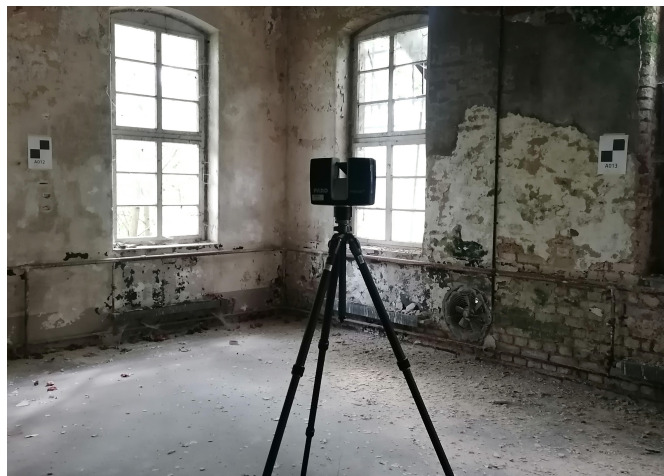
Abbildung 5.1: Faro Focus S150 mit 2 Schachbrettmarken im Hintergrund
