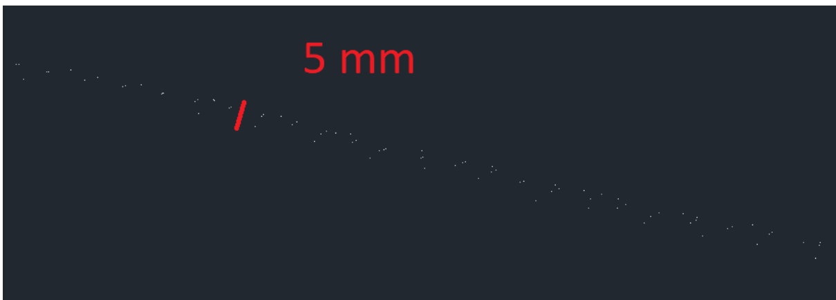
Abbildung 8.1: Punktfehler in AutoCAD
